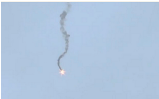
Notsignal-Leuchtkugel, abgeschossen mit einem Comet-Notsignalgeber. Hier ist ein wellenförmiger Bahnverlauf zu sehen.
